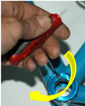
15. Fette das Lager und installiere es nach der rechten Kurbel – grease the bearing and install it after the right crank
