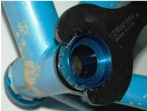
14. Fixiere den linken **exzentriker II** mit der Stiftschraube – fix the left **exzentriker II** with the setscrew
