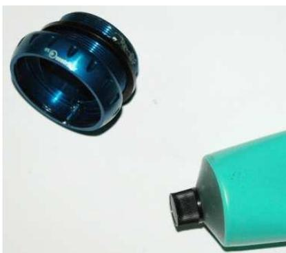
13. Montiere den linken **exzentriker II** und richte ihn am rechten aus indem der Innensechskantschlüssel durch den linken in den rechten **exzentriker II** gesteckt wird – install the left **exzentriker II** and align him with the right through inserting the allenkey through the left into the right **exzentriker II**
