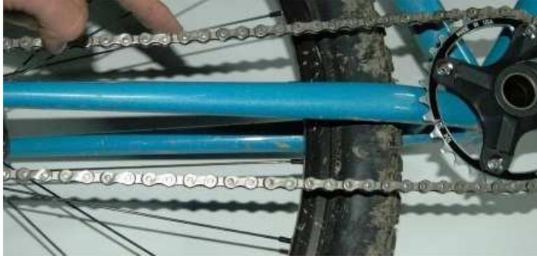
8. Für mehr Kettenspannung verdrehe den **exzentriker II** um ein paar Grad –
