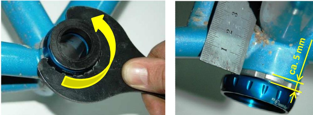
5. Drehe den **exzentriker II** mit der größten Auslegung auf 9:00 Uhr und montiere die rechte Kurbel –
