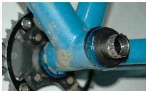
16. Montiere die linke Kurbel – install the left crank
