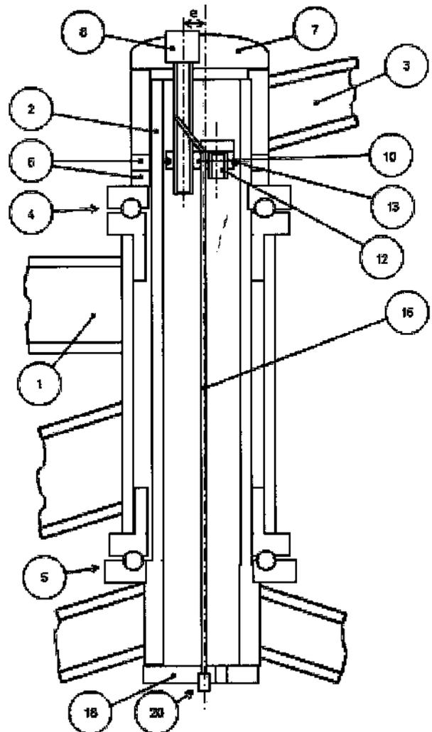
(57) Hauptanspruch: Einstell- und Spannsystem für den Steuersatz 4, 5 eines Fahrrades dadurch gekennzeichnet, dass die axiale Spannung zum Einstellen des Lagerspiels mittels Drehen einer Einstellschraube 8 in der oberen Verschlusskappe 7 und daher eine axiale Verlagerung der mittleren Zugeinheit 10 relativ gesehen weg von der unteren Verschlusskappe 18 erfolgt und der Bowdenzug 16 zwischen der mittleren Zugeinheit 10 und hierbei der unteren Verschlusskappe 18 gespannt wird.
